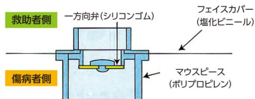
一方弁付呼吸吹き込み式人工呼吸時の感染防止具です。マネキンを用いた訓練時にも有用です。
