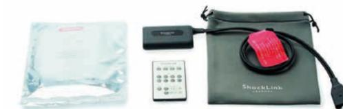
ShockLinkは現場で使用する実際の除細動器とトレーニングマネキンを接続して、安全でリアルなBLSトレーニングを可能にします。専用トレーニングパッドとShockLinkを介して除細動器実機に接続することにより、ショックのエネルギーを安全に消化します。
