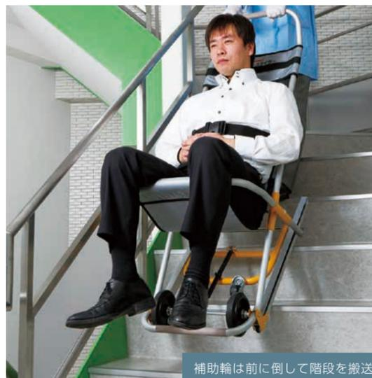
補助輪を前に倒して階段を搬送
